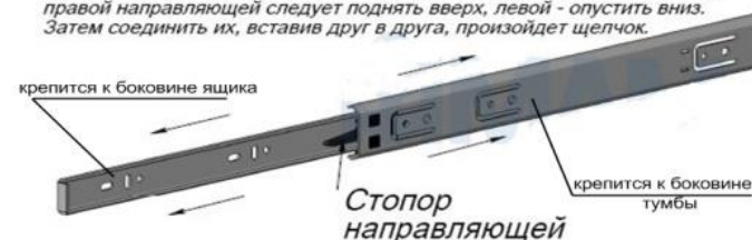
Рис.3 Схема установки шариковых направляющих
